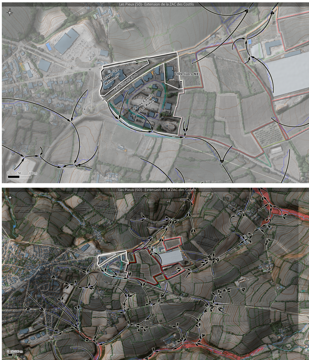
Figure 29 : Cheminement de eaux après rejet
