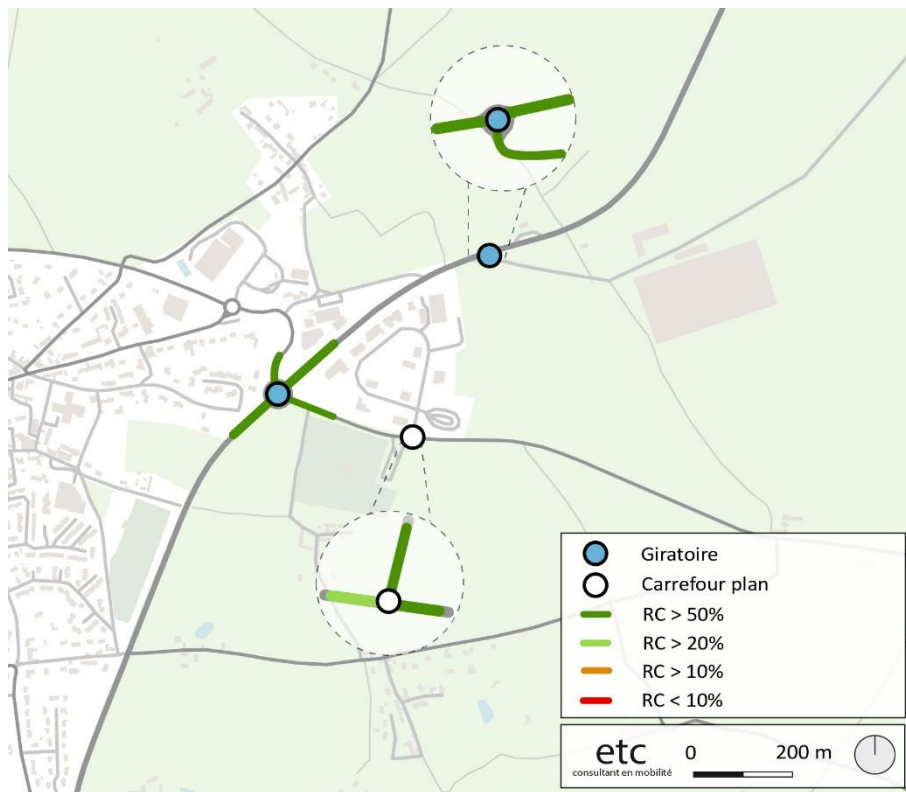
Réserves de capacité à terme à l'HPM (à gauche) et à l'HPS (à droite) – ETC
