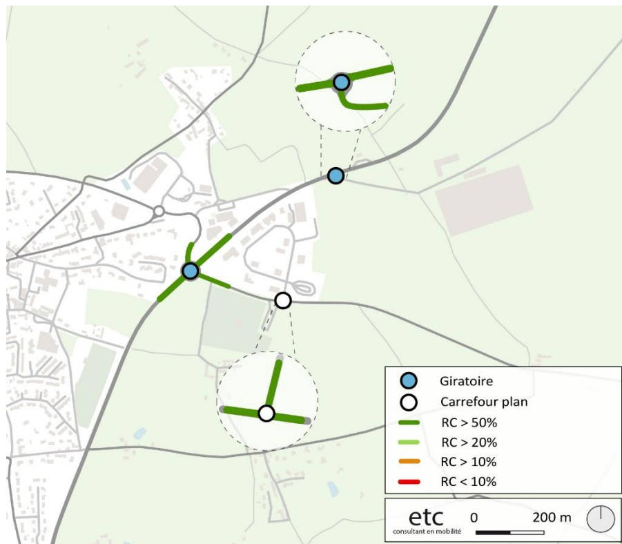
État de la circulation à l'état initial à l'HPM (à gauche) et à l'HPS (à droite) – ETC
