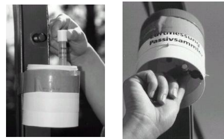
Figure 3 : Illustration de l'installation des tubes passifs - NO 2
